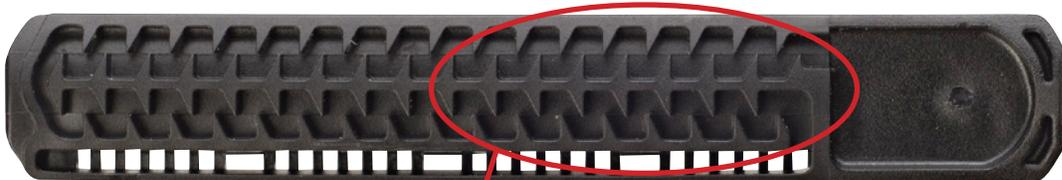
Laberinto de flujo ancho y dientes en ángulo - maximizan la velocidad del flujo de agua, que se desplaza así más rápidamente a través del gotero eliminando el taponamiento.
